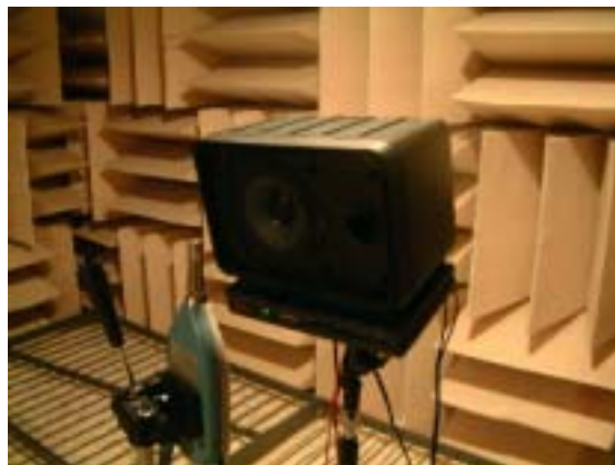
図 5-4-1 測定風景（スピーカユニットからの出力の測定）
