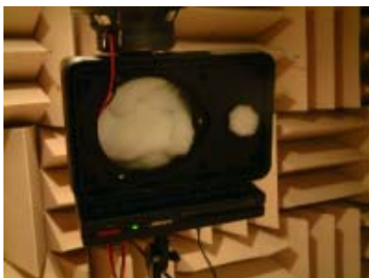
図 5-5-1 エンクロージャとバスレフホーンに吸音材を詰めた様子
