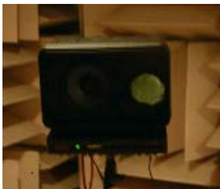
図 5-3-1 バスレフホーンに粘土を詰めた状態
